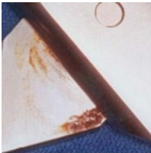
Korozija zaradi drgnjenja
