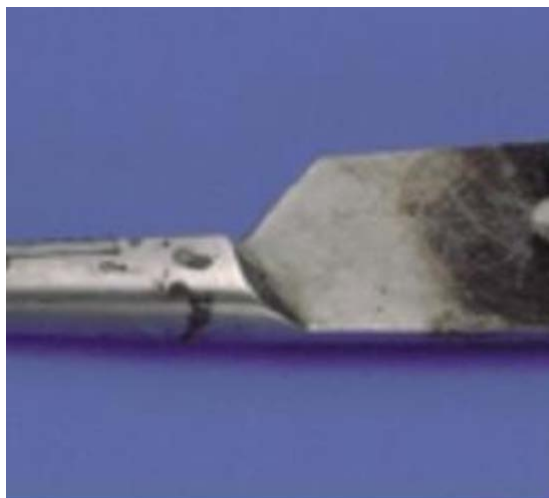
luknjičasta, jamičasta korozija
