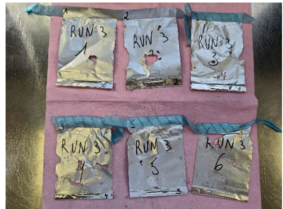
Schema 5: Visualisatie van de perforatie van aluminiumstrips met ultrasone golven
