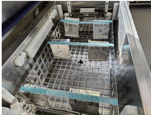
Schema 5: Visualisatie van de perforatie van aluminiumstrips met ultrasone golven
